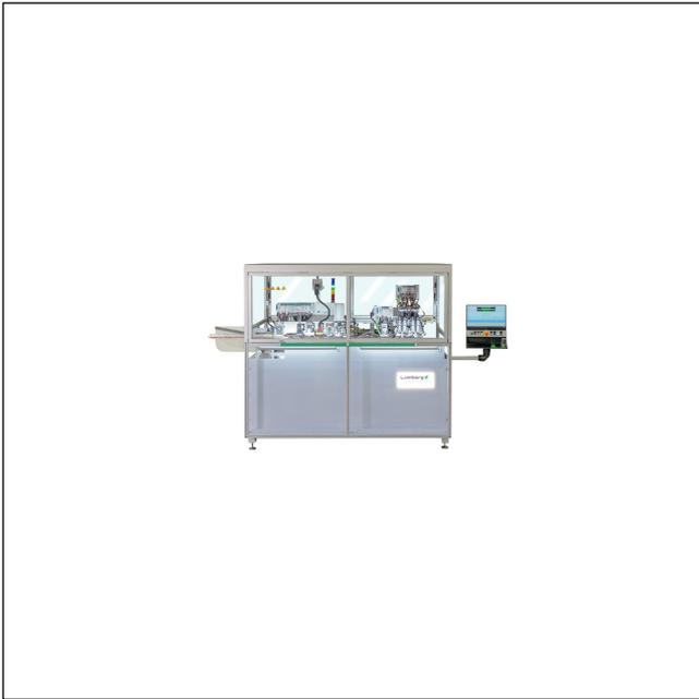
Vollautomatische Verarbeitungsmaschine für das Anschlagen von RAST-5-Steckverbindern in Schneidklemmtechnik (SKT), für viele Kabelbaumkonfigurationen
